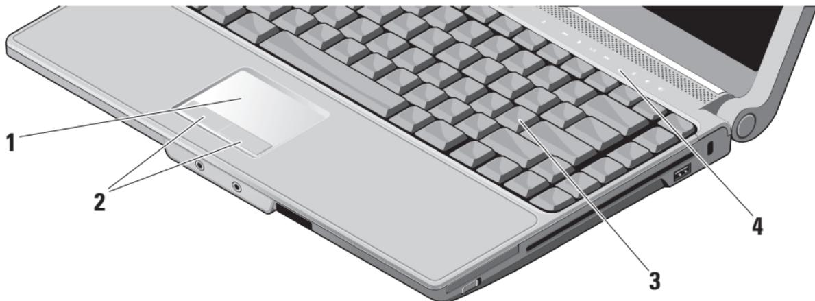
**1 Tablette tactile** – Offre les fonctionnalités d'une souris pour déplacer le curseur, faire glisser ou déplacer des éléments sélectionnés et cliquer à gauche en frappant sur la surface.
